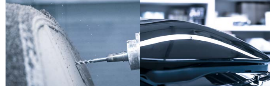
用于设计验证的油泥模型，在设计模型制造和设计工作室中完成。例如，成品零件模型使用硅胶模具来制造原型零件用于照明系统。
