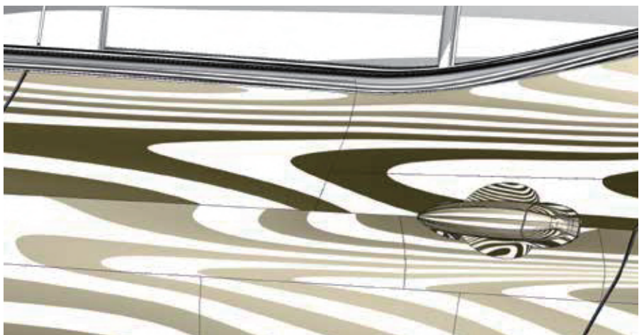
只需点击一个按钮，即可根据反射诊断（斑马阴影）实时查看Tebis生成的设计曲面的光顺度
