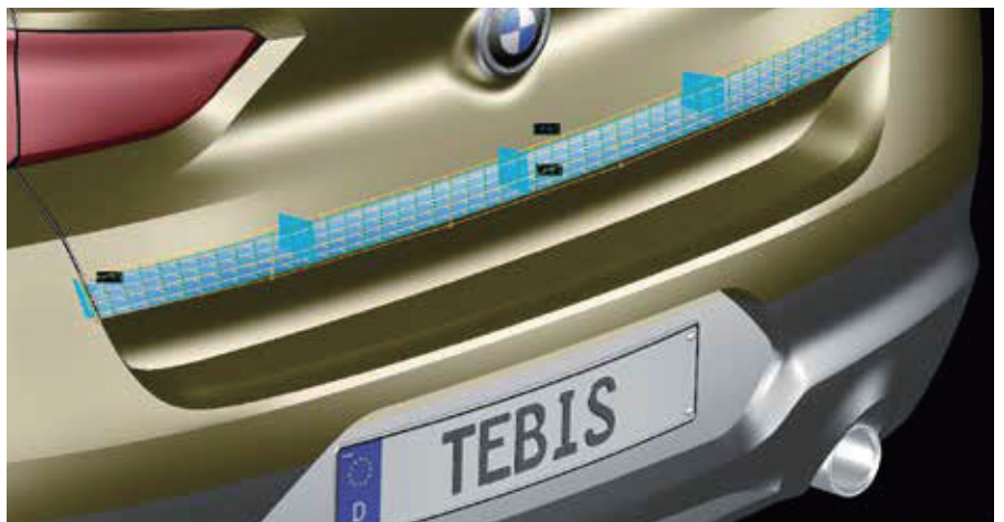
在逆向工程和曲面建模过程中，理论边缘自动保留在Tebis中。软件中提供特殊功能，可快速生成理论边缘
