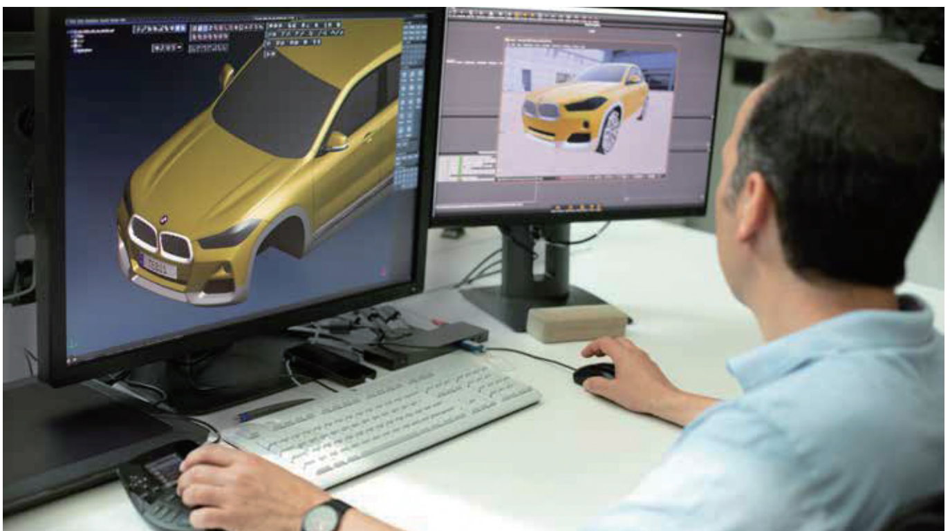
基于Tebis中生成的曲面模型（屏幕左侧），可在可视化工具（屏幕右侧）中准备宝马X2的渲染图
