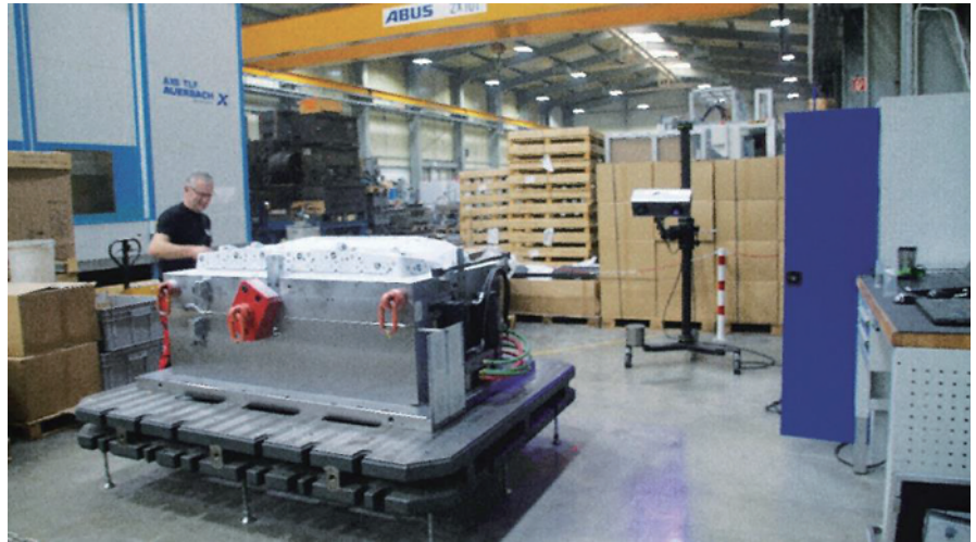
用于实现质量保证的光学仪器现在已成为大型模具制造商日常生产的一部分。将数据仔细地记录下来，而不仅仅是为了客户进行记录。
