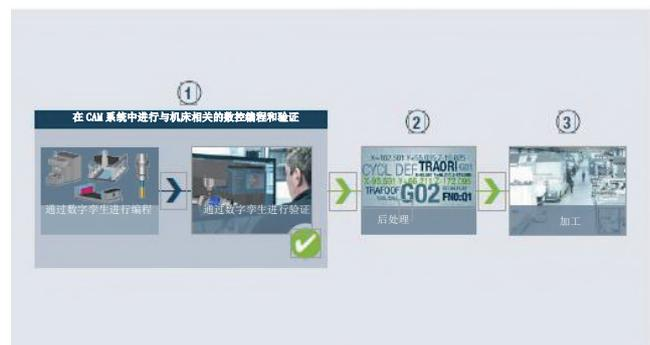
在第二种方法中，使用真实生产环境的数字化孪生镜像技术在 CAM 环境中进行规划、编程和刀路验证，包括所有机床信息。
