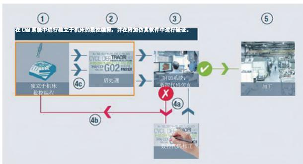
在这种方法中，首先在 CAM 系统中独立于机床进行数控编程。然后添加机床信息。使用附加仿真软件对刀路进行验证。
